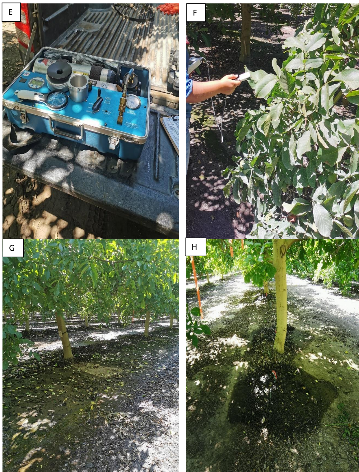
Figura 4. Aplicación de tratamientos mediante maquina pulverizadora con pitón (A), condición de las plantas al momento de aplicación "B" (B), cambio de aspersores (C) medición de humedad de suelo con TDR (D), Cámara Scholander para evaluación de potencial hídrico (E) evaluación de conductancia estomática de hoja (F), Plantas con riego campo (G) y plantas con una restricción del 30% de riego.
